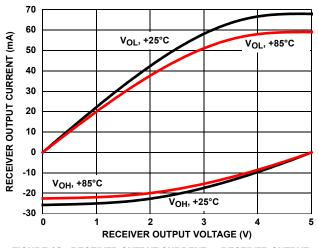
FIGURE 13. RECEIVER OUTPUT CURRENT VS RECEIVER OUTPUT VOLTAGE
