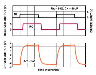
FIGURE 26. DRIVER AND RECEIVER WAVEFORMS (ISL32475E)
