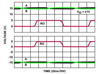
FIGURE 24. RECEIVER PERFORMANCE WITH ±15V CMV (ISL32478E)
