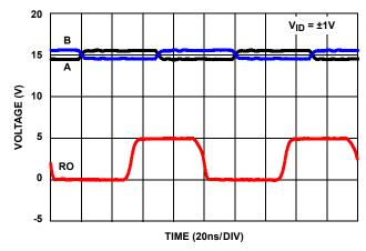
FIGURE 1. EXCEPTIONAL Rx OPERATES AT >15Mbps EVEN WITH +15V COMMON MODE VOLTAGE
