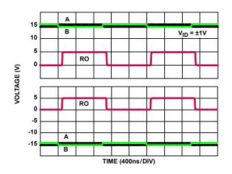
FIGURE 23. RECEIVER PERFORMANCE WITH ±15V CMV (ISL32475E)
