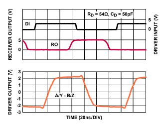
FIGURE 27. DRIVER AND RECEIVER WAVEFORMS (ISL32478E)
