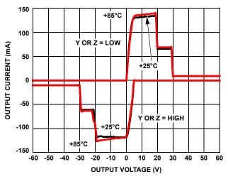
FIGURE 14. DRIVER OUTPUT CURRENT vs SHORT CIRCUIT VOLTAGE
