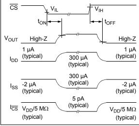
FIGURE 1-4: Chip Select (MCP6V28).
