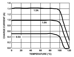
FIGURE 5. CHARGE CURRENT vs AMBIENT TEMPERATURE
