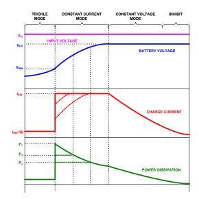
FIGURE 18. TYPICAL CHARGE CURVES USING A CONSTANT-VOLTAGE ADAPTER
