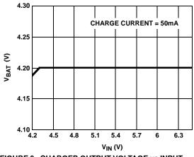
FIGURE 3. CHARGER OUTPUT VOLTAGE vs INPUT **VOLTAGE CHARGE CURRENT IS 50mA**
