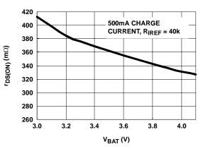
FIGURE 10. r<sub>DS(ON)</sub> vs OUTPUT VOLTAGE USING CURRENT LIMITED ADAPTERS
